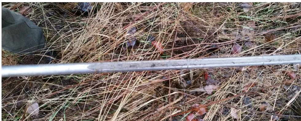
Figur 2: Sonde med prøvesliss. Her: hard, leirig silt.
