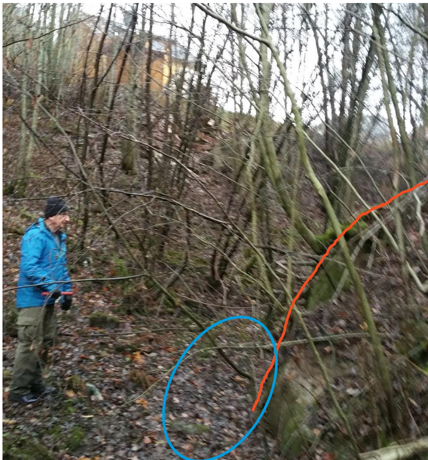
Figur 5: Bunnen av ravinen. Berghammer til høyre, markert med rød strek. Bløt leire markert med blå sirkel. Tatt mot sør-sørvest.
